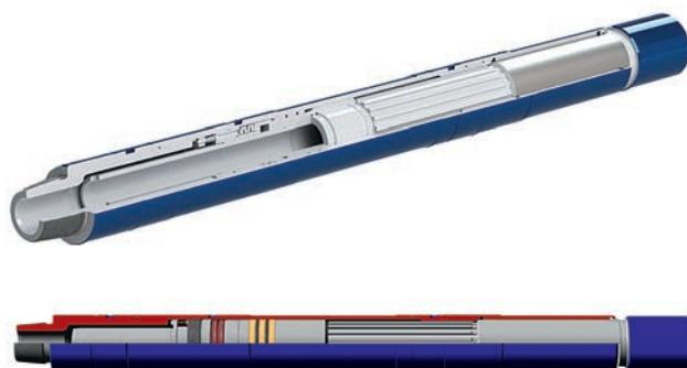
**Корректор подачи – демпфер (КПД)** предназначен для обеспечения оптимального равномерного нагружения долота осевой нагрузкой при бурении наклонно направленных и горизонтальных участков скважин, в случаях, когда движение бурильной колонны в результате значительных сил трения осуществляется неравномерно, с одновременным гашением продольных колебаний, возникающих в компоновке низа бурильной колонны (КНБК).
