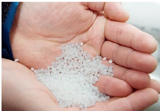
**Полиэтилен суспензионный высокой плотности модифицированный марки СНОЛЕН IM 7,5/50**
